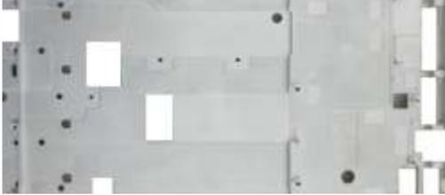
HA6可阳极氧化压铸铝合金系列，抗拉强度120-200MPa，屈服强度90-120MPa，延伸率8-15%，硬度45-60HV0.2。可压铸后直接多彩阳极，应用于智能家居、显示器底座、无线底座、电子烟等产品，大幅降低原CNC加工方式的成本。
