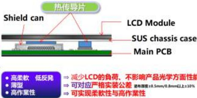
C、高柔软性高导热碳纤维( $>=6\text{W/m-K}$ )导热垫-5G终端/车用/设备（高绝缘性版本也可提供）
